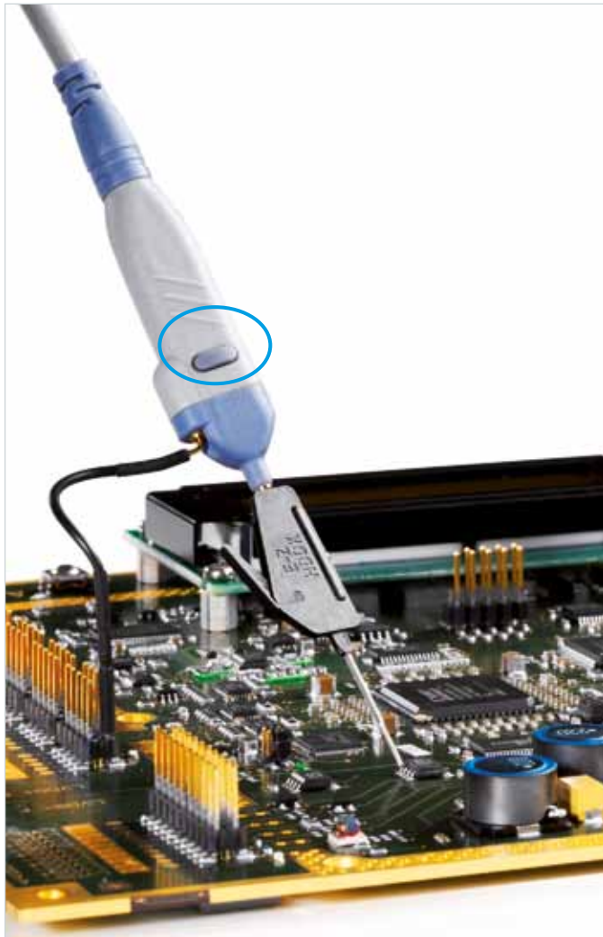
Praxisgerecht ausgelegt: Mikrotaster zum komfortablen Steuern des Geräts. Vielfältige Messspitzen und Massekabel sind bereits im Standardlieferumfang enthalten.
