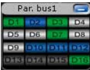
Die Signalaktivität der digitalen Kanäle wird im Signal-Icon unabhängig von der Erfassung dargestellt.
